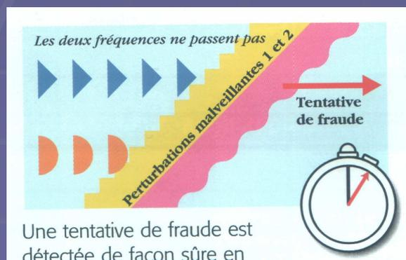
*Si l'une des deux fréquences est perturbée par des parasites ou d'autres émetteurs, c'est l'autre fréquence qui assure la transmission*
