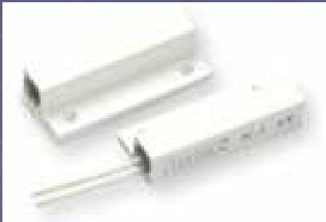
Ces détecteurs sont installés sur les issues ou ouvrants à protéger. Ils se montent en saillie ou encastrés. Ils se compose de deux parties, une partie fixe contenant un contact (ILS : Interrupteur à lame souple) installée sur l'huissérie et une partie mobile contenant un aimant, installée sur l'ouvrant. Lorsque l'aimant s'éloigne du contact, les deux lames de l'ILS se séparent et le contact s'ouvre.
