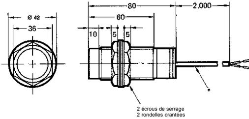
\*E2K-X15ME1(2): Câble en PVC isolé (résistant aux vibrations et insensible à l'huile)
