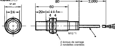
\*E2K-X8ME1(2): Câble en PVC isolé (résistant aux vibrations et insensible à l'huile)
