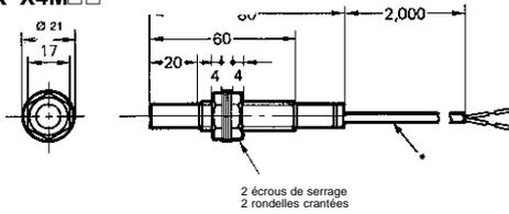
\*E2K-X4ME1(2): Câble en PVC isolé (résistant aux vibrations et insensible à l'huile)
