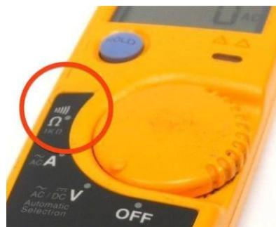
*Image Appareil de mesure : ohmmètre ou testeur de continuité* **La mesure est effectuée hors tension entre le bornier de terre de l'armoire (barrette PE) et l'ensemble des points de masses métalliques accessible :**
