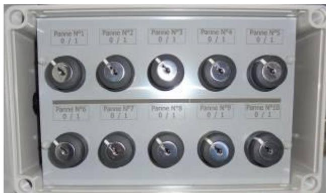
Vous avez la possibilité de créer des pannes sur le système HYDRO-3 en actionnant les commutateurs à clé se trouvant dans la boîte à pannes.
