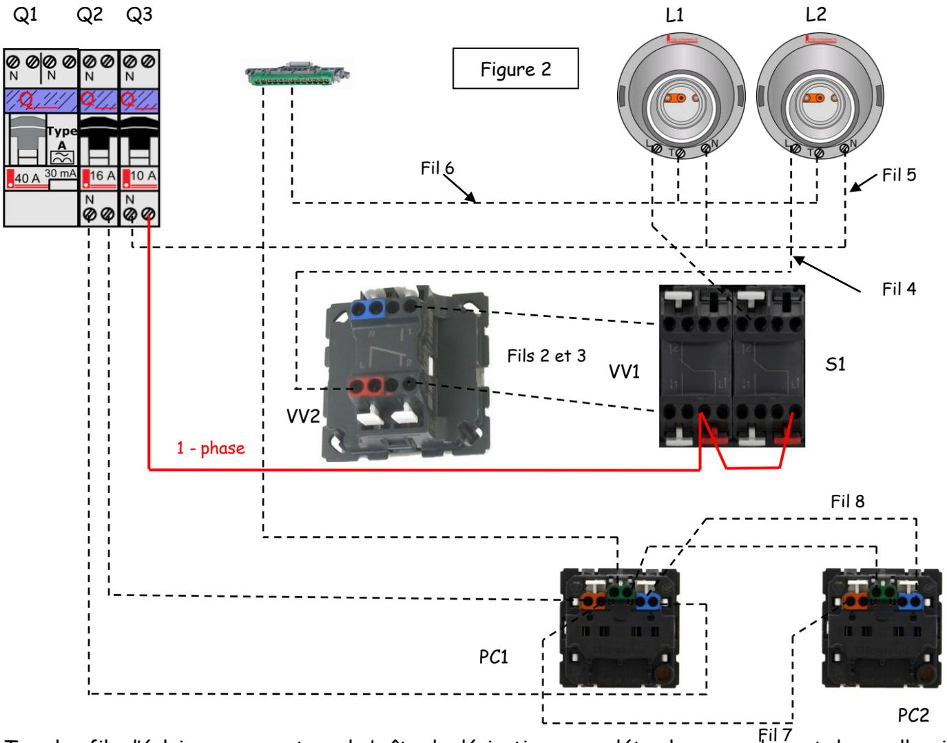
Tous les fils d'éclairage passent par la boîte de dérivation : compléter le raccordement dans celle-ci
